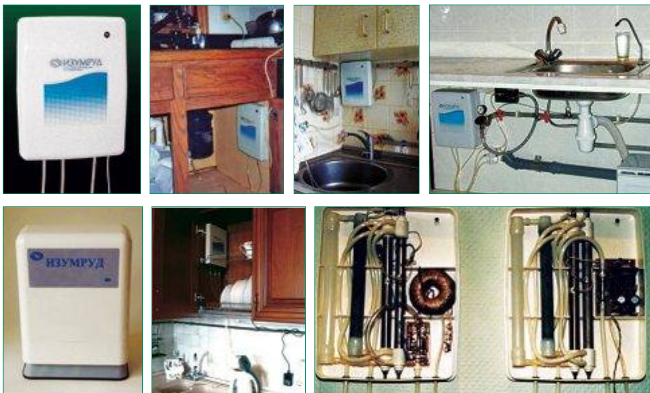
Установки ИЗУМРУД. 1 — самая первая модель установки ИЗУМРУД, разработанная и изготовленная В.Бахиrom и Ю. Задорожним в 1990 году. В установке использован первый образец элемента ПЭМ-2. Кооператив «АСПЕКТ», Москва, 1990. 2 — модель 1991 года. 3 — модель 1993 года. 4 — модель 1995 года. Москва, СП «ЭМЕРАЛЬД», 1995. Установки, изображенные на фото 2–4 изготавливались серийно совместным российско-британским предприятием «ЭМЕРАЛЬД», в числе учредителей которого были авторы.
