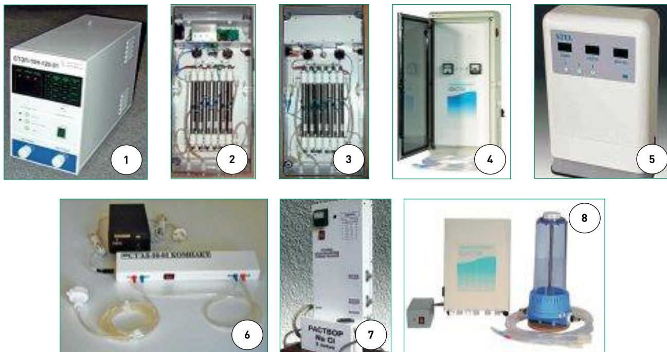
1, 5 — установки СТЭЛ-80. 2, 3, 4 — стадии изготовления установки СТЭЛ-120. 6 — установка СТЭЛ-Компакт производительностью по анолиту АНК 10 л/ч для использования в полевых условиях и на транспорте. 7, 8 — установки СТЭЛ-40 и СТЭЛ-20 для сельских больниц.
