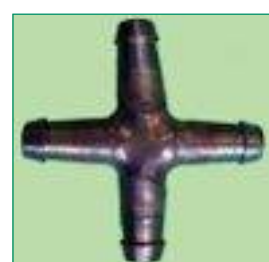
Фитинги из титана ВТ1-00. Диаметры проходных сечений (Ду) от 4 до 8 мм. Предназначены для сочленения гибких шлангов из ПВХ или фторопласта Ф4-МБ.
