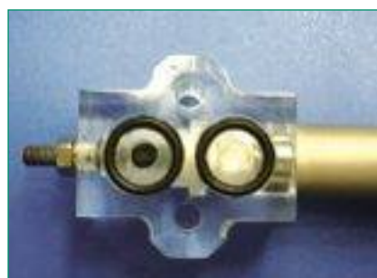
В 1997 году техническими специалистами мемориального института «Battelle» (США) с целью достижения большей компактности реактора РПЭ-С-36 были совместно с авторами элементов ПЭМ-3 разработаны коллекторные втулки для элементов ПЭМ-3. Прототипом этой разработки явились ранее созданные Ю.Г. Задорожним и В.М. Бахиром в 1992 году коллекторные втулки для элементов ПЭМ-2 (фото внизу слева).
