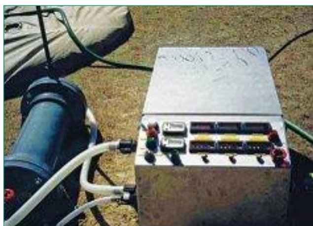
Установка СТЭЛ с элементами ПЭМ-3 для морских пехотинцев США во время полевых испытаний на полигоне в Атланте, 1996. Элементы ПЭМ-3 смонтированы в трех реакторах РПЭ-С-36 (по 36 элементов ПЭМ-3 в каждом).
