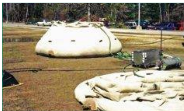
Установка СТЭЛ с элементами ПЭМ-3 для морских пехотинцев США во время полевых испытаний на полигоне в Атланте, 1996. Элементы ПЭМ-3 смонтированы в трех реакторах РПЭ-С-36 (по 36 элементов ПЭМ-3 в каждом).
