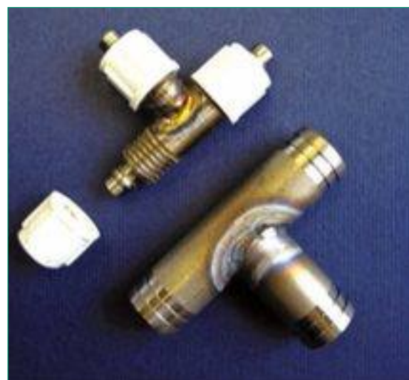
Фитинги из титана ВТ1-00. Диаметры проходных сечений (Ду) от 4 до 8 мм. Предназначены для сочленения гибких шлангов из ПВХ или фторопласта Ф4-МБ.
